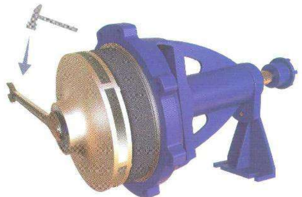
شکل ۲۰- باز کردن مهره شش گوش پروانه
