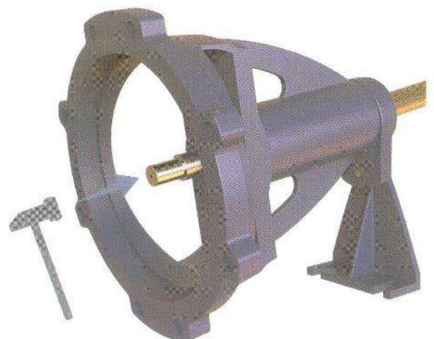
شکل ۲۵- خارج نمودن محور از روی پایه یاتاقان
