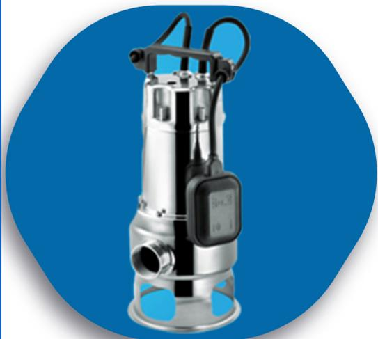
پمپ لجنکش سانتریفیوژی و تمام استیل پنتاکس سری DX، در ۶ مدل زیر بصورت تکفاز و فلوتر دار و بدون فلوتر توسط پایاگسترش وارد کشور می شود. این پمپ در برابر سیالات متفاوت و حتی ساینده و چسبناک مقاوم است و در مصارف انتقال سیال خانگی، صنعتی، رستورانی و... کاربرد دارد. حرف G نشانگر فلوتر دار بودن و عدد بعد از اسلش سایز دهانه خروجی بر حسب اینچ است. همچنین این سری درجه محافظتی IP68 و کلاس عایق بندی F دارد.
